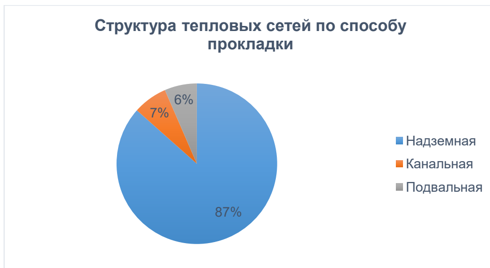
Рисунок 7 – Структура тепловых сетей по виду прокладки
