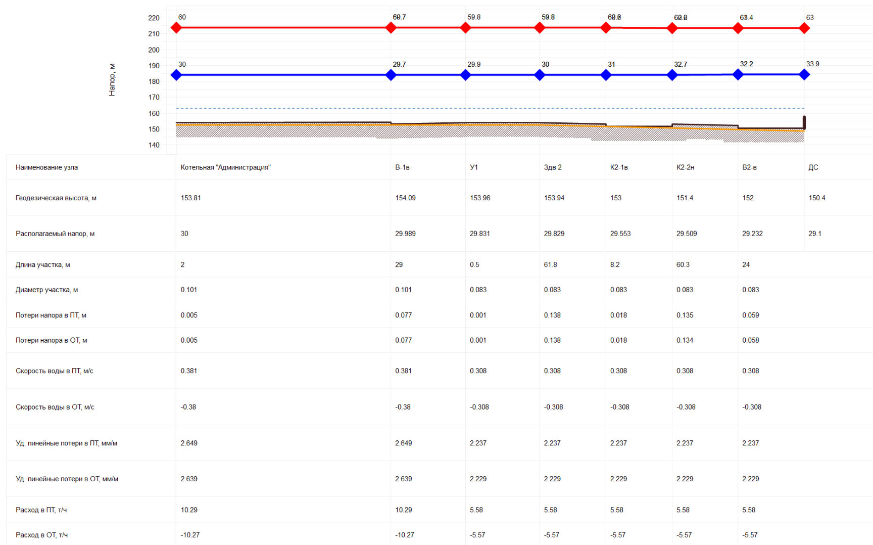
Рисунок 11 – Пьезометрический график тепловой сети на участке № 2
