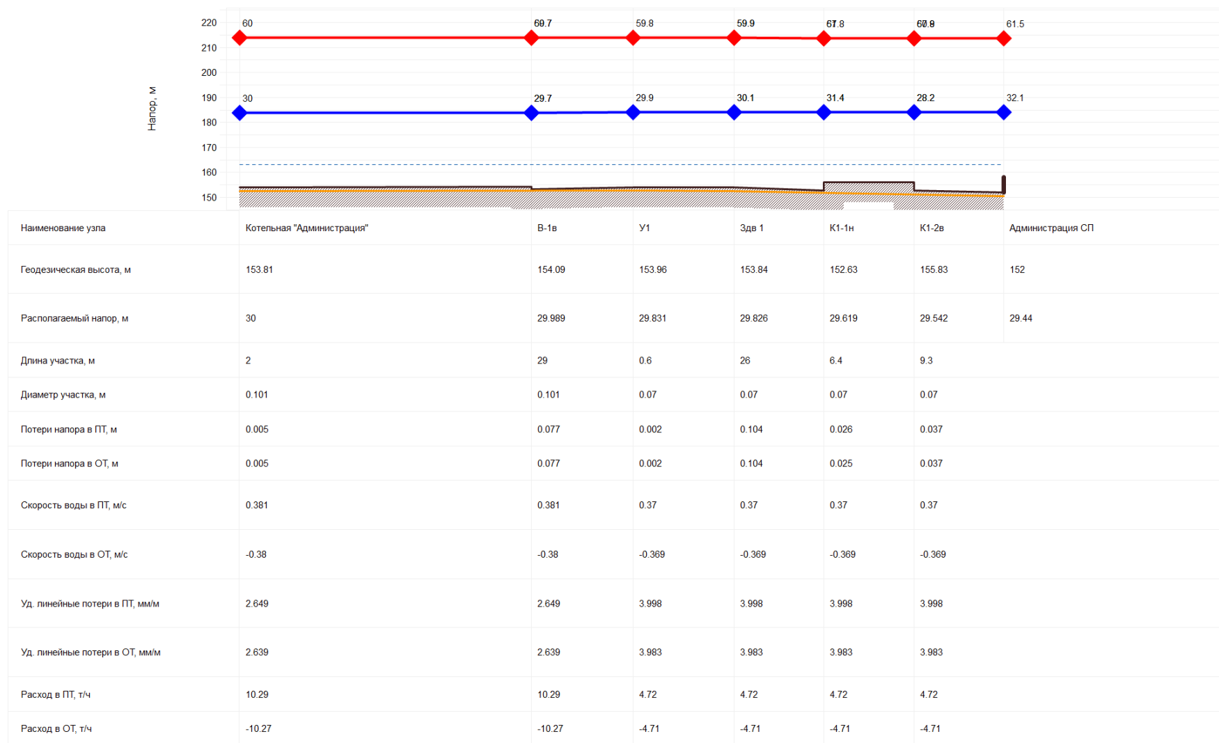
Рисунок 9 – Пьезометрический график тепловой сети на участке № 1
