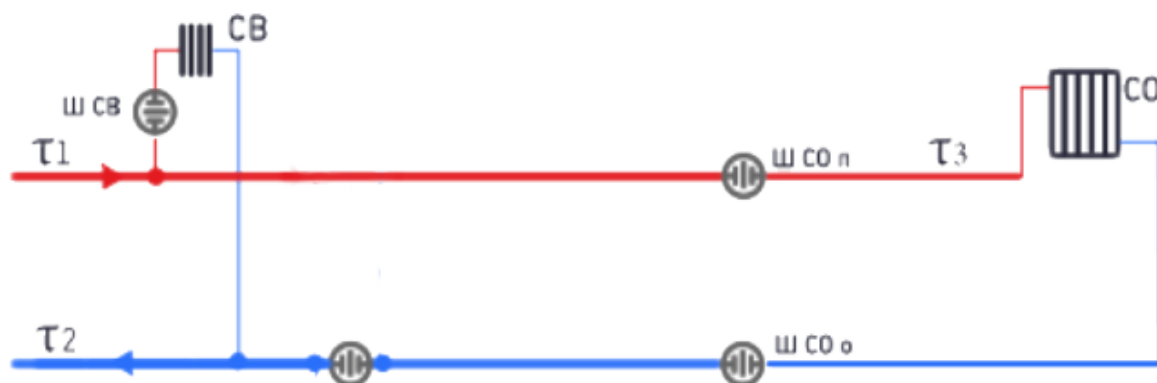
Рисунок 28 – Схема присоединения теплопотребляющих установок (система отопления) потребителей к тепловым сетям
